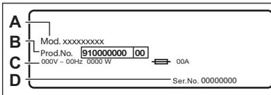
Das Typenschild enthält den Modellnamen (A), die Produktnummer (B), elektrische Daten (C) und die Seriennummer (D).
